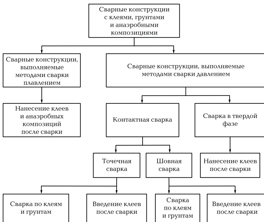
Рис. 6.1. Схема классификации основных типов сварных конструкций с клеями, грунтами и анаэробными композициями
