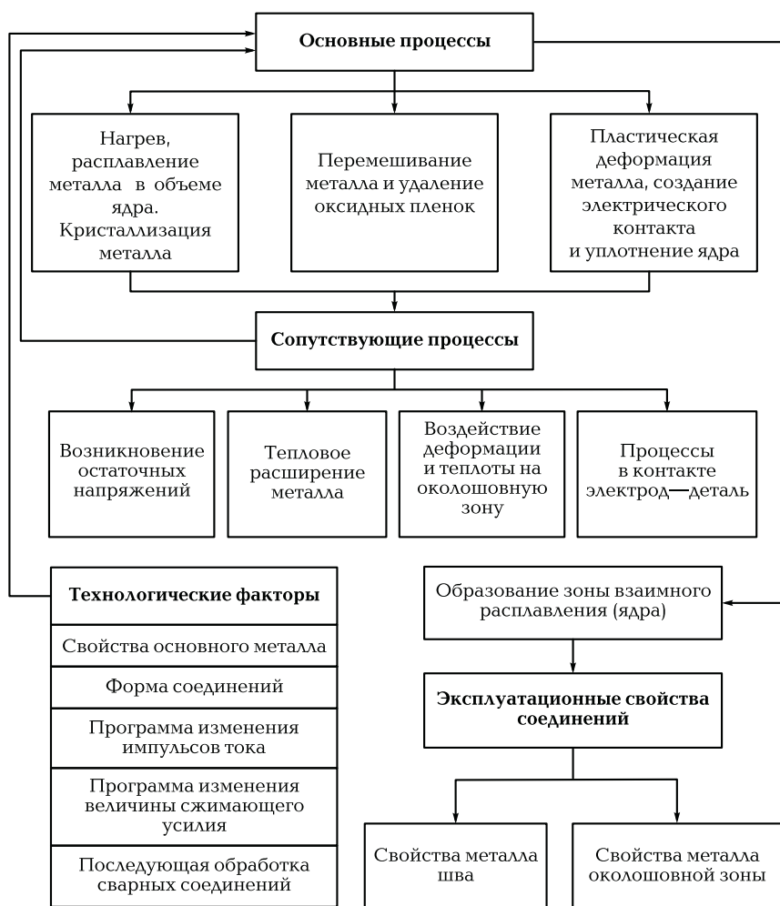
Рис. 1.2. Схема процессов образования соединений при контактной точечной сварке
