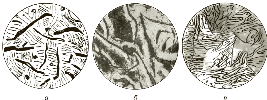
Рис. 19.1. Микроструктура серого чугуна:
